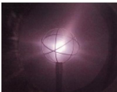
放電中の慣性-静電閉じ込め核融合中性子源：球状グリッド陰極の中心にイオンが収束して光り輝いている様子が観測される
