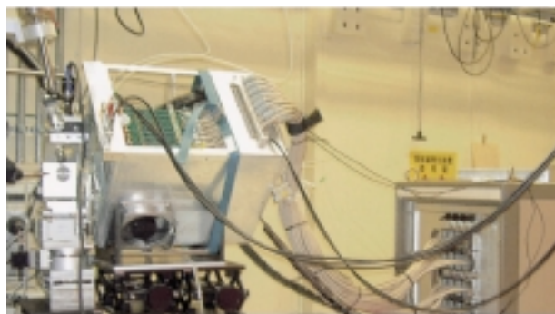
図2：データ測定中の MSGC を搭載した回折装置（Spring-8 にて）
