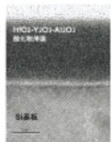
図3 透過型電子顕微鏡による構造評価。図2で丸で示した領域が非晶質であることが確認された。
