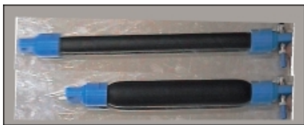
図1 空気圧ゴム人工筋の動作
