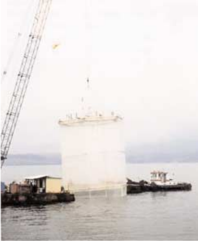
琵琶湖国際共同観測の時に北湖に設置された 巨大隔離水塊（直径10m、長さ30m）
