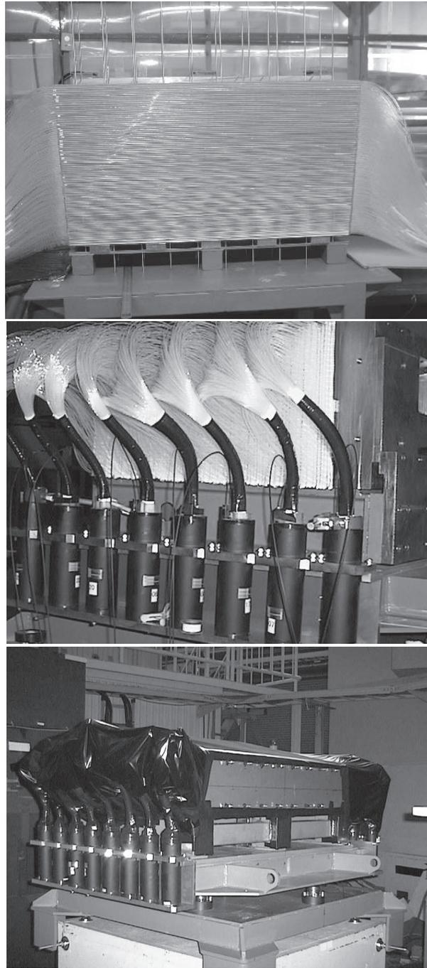
Fig. 4. 上段の写真は、鉛シート、TiO<sub>2</sub>PETシート、プラスチックシンチレーターを積層している様子である。左右からWLS Fiberが出ている。中段の写真は、WLS FiberにPMTを装着した写真で、全ての光シールドを終え、架台に据え付けられた状態が下段の写真である。
