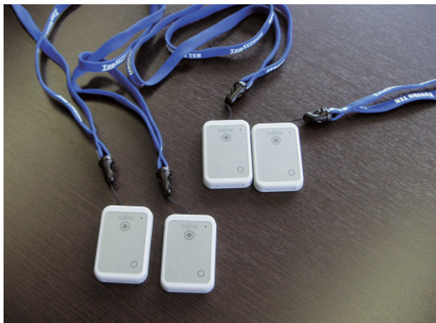
Tag Station の RFIDタグ（TGS-T310） 電池を内蔵するため、やや厚みがある
