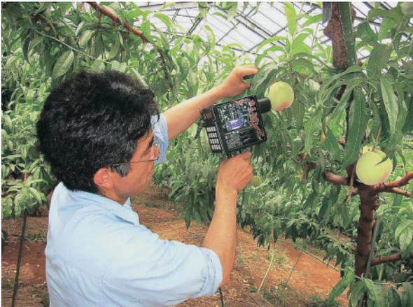
（写真3）試作した携帯型糖度計
