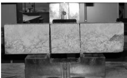
(b) 最大荷重時のひび割れ状況
