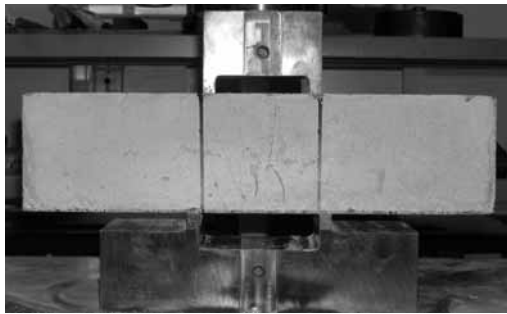
(b) 最大荷重時のひび割れ状況
