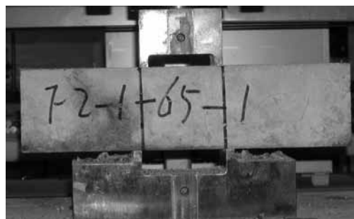
(b) 最大荷重時のひび割れ状況
