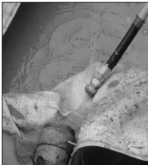
写真2 洗浄試験での水の噴射
