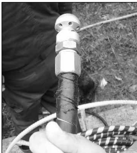
写真3 推進力を与える後方向き孔
