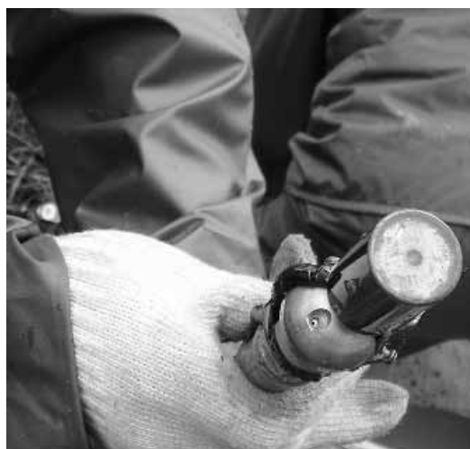
写真5 内視カメラを取り付けた洗浄のノズル
