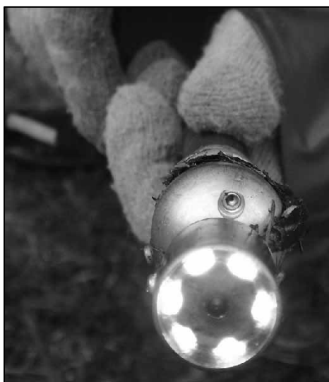
写真6 ノズル先端カメラからの発光 (中央部がカメラである)
