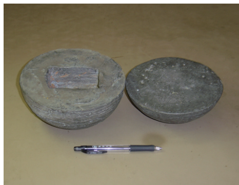
写真1 理学部に残る古い鉛シールド a (上) 上半分と下半分を重ねた状態 b (下) 上半分と下半分を離した状態
