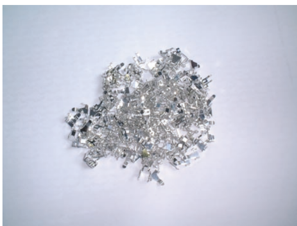
図1 鉛フリーはんだめっきをした電子部品
