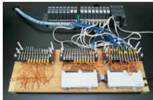
火災実験データをデジタルデータとして収集する装置。火災発生からの時間経過による各部位の温度を記録する
