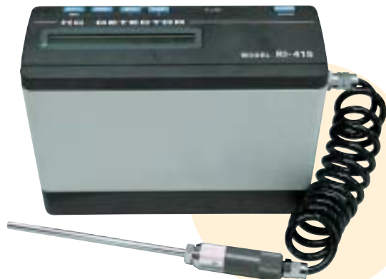
ガソリン蒸気濃度計。ガソリンは室温で極めて引火性の高いガソリン蒸気を発生するため、ガソリンを用いた燃焼実験は周囲に可燃性混合気が形成されていないか、細心の注意を払う必要がある
