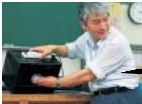
紫外線ランプを当て、鉱物に含まれている蛍光物質を見分ける
