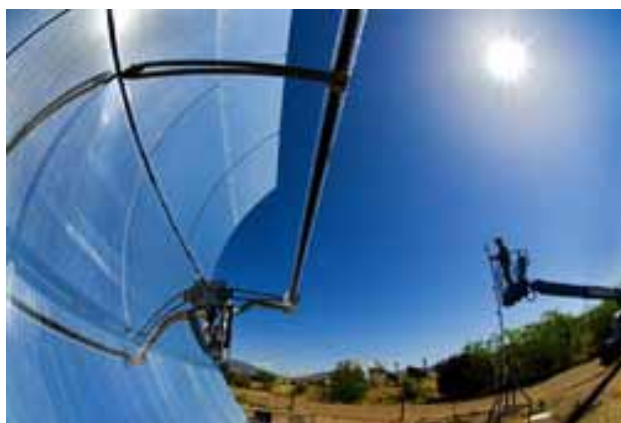
図1 サンディア国立研究所の放物（パラボラ）トラフ太陽熱集光システム
