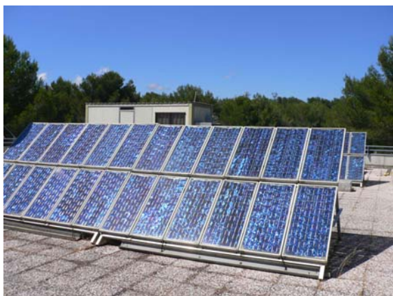
隣接するパリ国立高等鉱業学校屋上の太陽電池試験設備。もともと 20 年前に街灯用のデモに使用したもの。20 年以上の耐久性を証明している。
