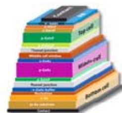
さまざまな太陽光子を吸収するように設計された多層構造の三接合太陽電池
