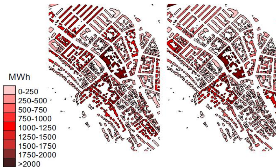
図1 左：レーザースキャニング+地図・物件データ照合、右：実際の熱需要データ
