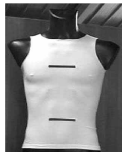
図 5. 呼吸モニタリング用 ピエゾ抵抗センサー
