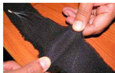
図 3. 布地に織り込まれたプラスチック光ファイバー (Penelope 社)
