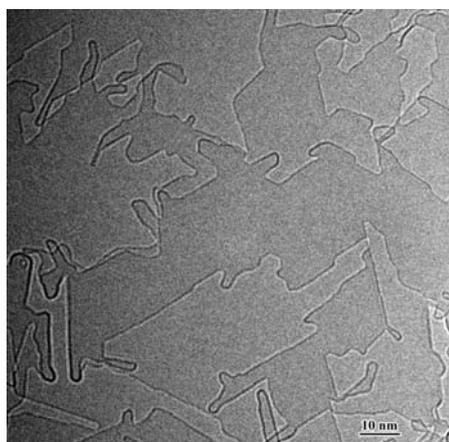
グラフェン基板上で、相互連結したカーボンナノ構造が形成される様子を示した電子顕微鏡写真。将来の電子デバイス作製に利用できる可能性がある。
