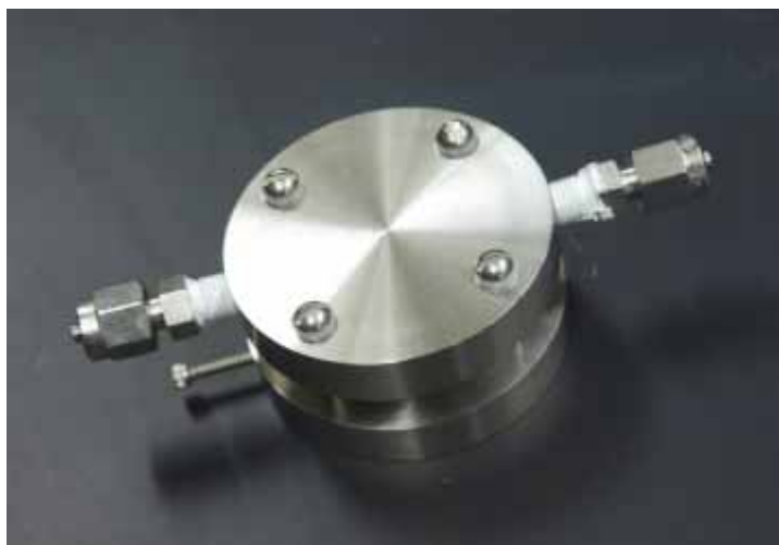
電池の側面には吸気口と排気口があり、空気の流れを生み出して電池が機能するための酸素を供給している
