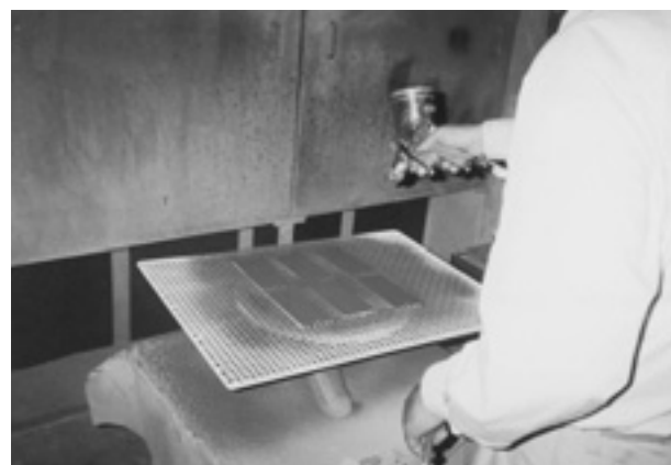
「廃発泡スチロールの塗料化に関する研究」 試作塗料の塗装作業
