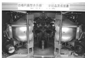
四楕円鏡型キセノンランプ集中加熱炉
