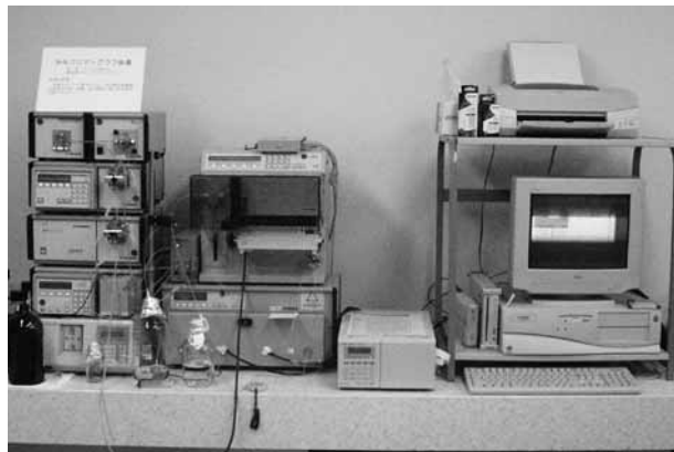
図3 HPLC装置 （ギルソンメディカルエレクトロニクスS.A.社製）
