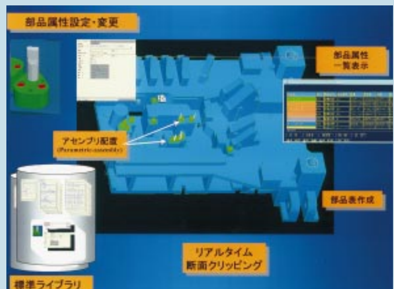
写真3 プレス型構造設計・製作支援システムの適用例
