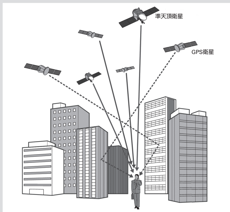
図3 準天頂衛星システムの概要
