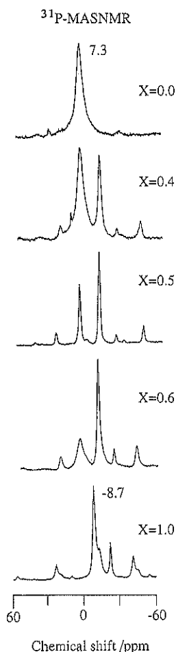
図4 \text{Zr}[(\text{O}_3\text{PCH}_2\text{SO}_3\text{H})_x(\text{O}_3\text{PC}_{12}\text{H}_{25})_{1-x}]_2 の ^{31}\text{P} -MASNMR スペクトル ( x の割合(複合比)を変化させたときの ^{31}\text{P} -MASNMR スペクトル)
