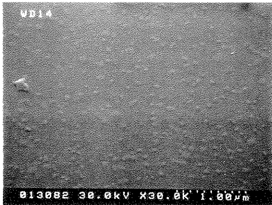
図5 \text{SrTiO}_3 (100) 基板上へ 650^\circ\text{C} にて結晶化したエピタキシャルPZT薄膜のSEM像
