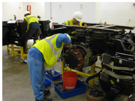
図5 台車点検の様子
