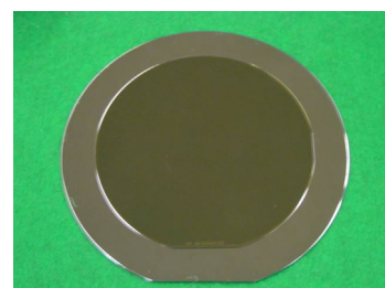
図7 炭化シリコン( \text{SiC} )とシリコン( \text{Si} )の接合事例
