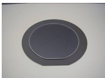
図5 ニオブ酸リチウム( \text{LiNbO}_3 )とシリコン( \text{Si} )の接合事例
