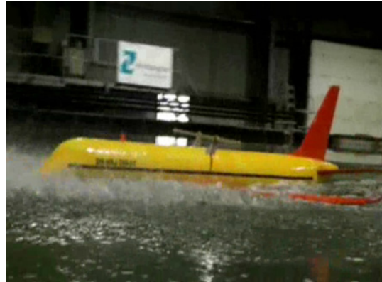
④胴体が完全に接水し、加速度が収束した状態.
