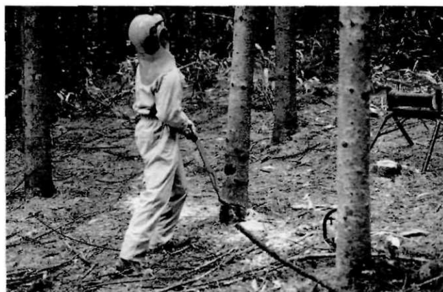
写真-6 フェリングレバーを使った伐倒作業
