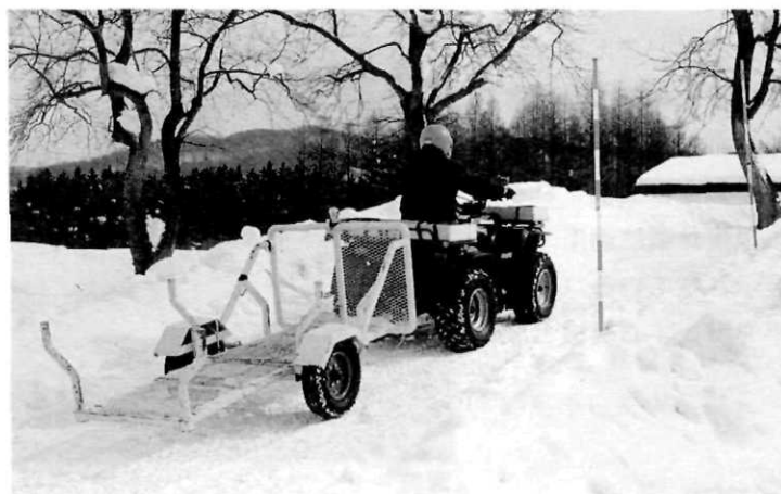
写真-3 積雪路における登坂走行試験のようす
