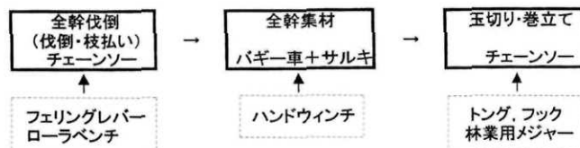
図-1 バギー車を利用した間伐作業システム
