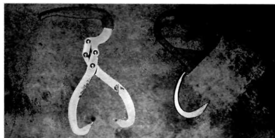
写真－10 短幹材の積込み、荷おろしに使用されるトング(左側)とフック
