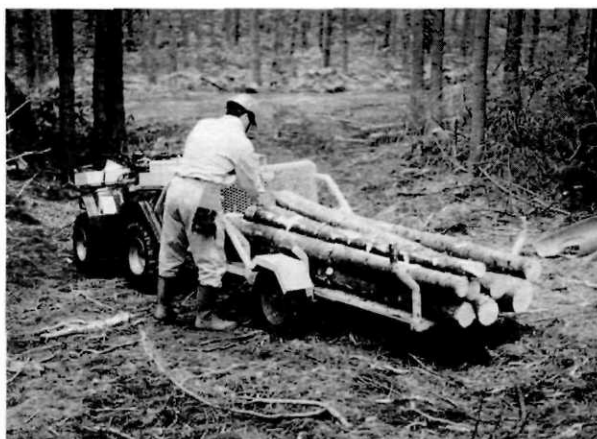
写真-4 短幹作業システムにおける集材作業
