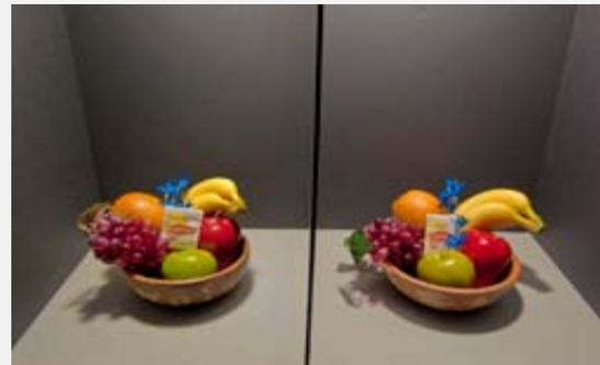
実験用セットアップでは、中央部で仕切ったライトボックスに相似したフルーツボウルを置いた。写真中2つのボウルはそれぞれダイオード・レーザーと標準的な白熱灯で照らされている。ダイオード・レーザー(左側)の審美的クオリティは、白熱灯(右側)のそれに遜色がない(写真: Randy Montoya)。
