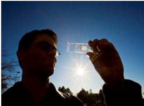
サンディア・プロジェクト主任研究員 Greg Nielson 氏が手にしているのは、極小サイズのレンズアレイが固定されているテストプロトタイプソーラーセル。これらを合わせれば、電池とレンズが集光型太陽光発電装置の製造に役立つ。(写真提供: Randy Montoya)
