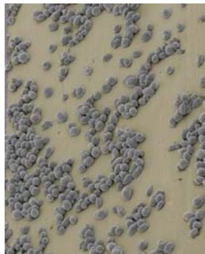
これらのマイクロカプセルは、液体金属で満たされており、金の導電性の層に付着している。回路が機械的ダメージを受けると、このカプセルがはじけて導電経路を修復する。各カプセルの直径は、わずか 10 ミクロンで、10 個並べるとちょうどヒトの髪の毛の直径に相当する。
