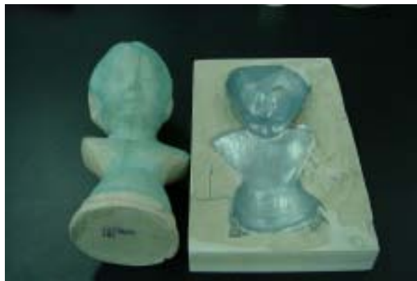
写真7 溶射モールドによる金型作成
