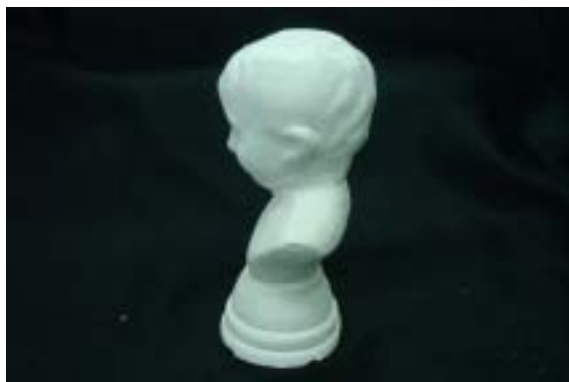
写真6 紙積層装置で作成したモデル はないものと考えられる。
