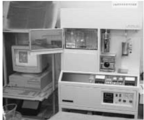
写真1 蒸気吸着量測定装置
