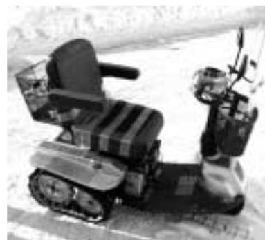
図5 ゴムクローラ式冬型電動車椅子
