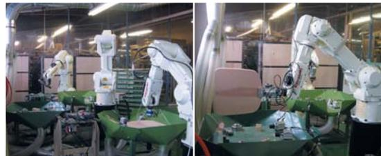
多関節ロボットによる木製品の自動加工システム
