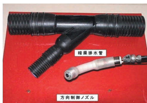
農地保全の低コスト化に役立つ 暗渠排水管検査・洗浄システム
