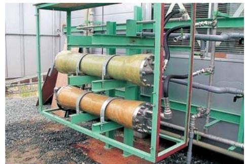
円筒形なのが300mの落差がある水力発電用ダムと同等の能力を持つ
