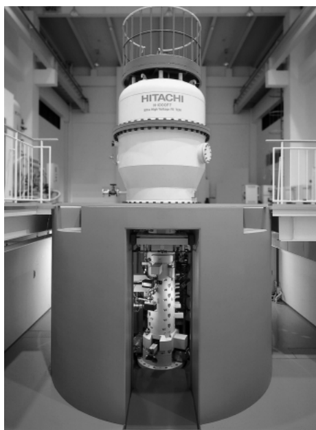
図3 1 MV電界放出型電子顕微鏡 (本装置は、独立行政法人科学技術振興機構の戦略的基礎研究推進事業の一環として開発されたものである。)
