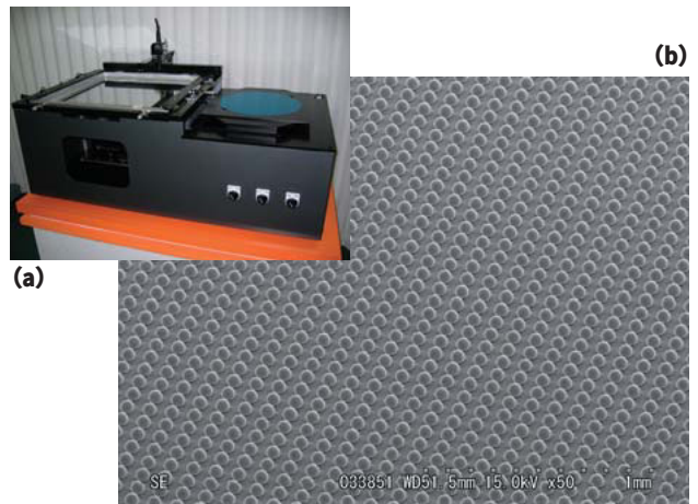
12 インチ対応手動マウンタ (a) と、直径 60 \mu m / ピッチ 100 \mu m のバンプ外観 (b) (ウェーハ提供: 株式会社日立超 LSI システムズ)
