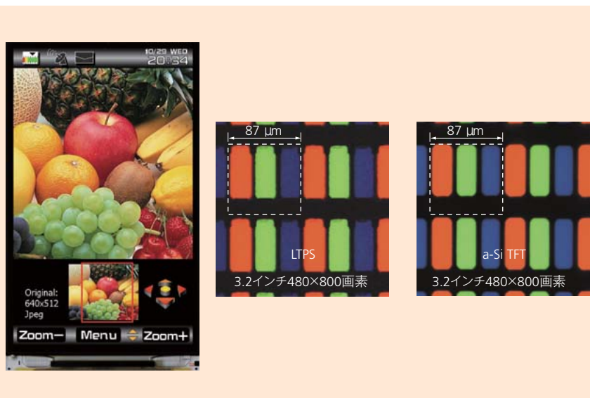
1 携帯機器用3.2インチワイドVGAパネルの外観(左), LTPSとa-Si TFTの画素比較(右)
