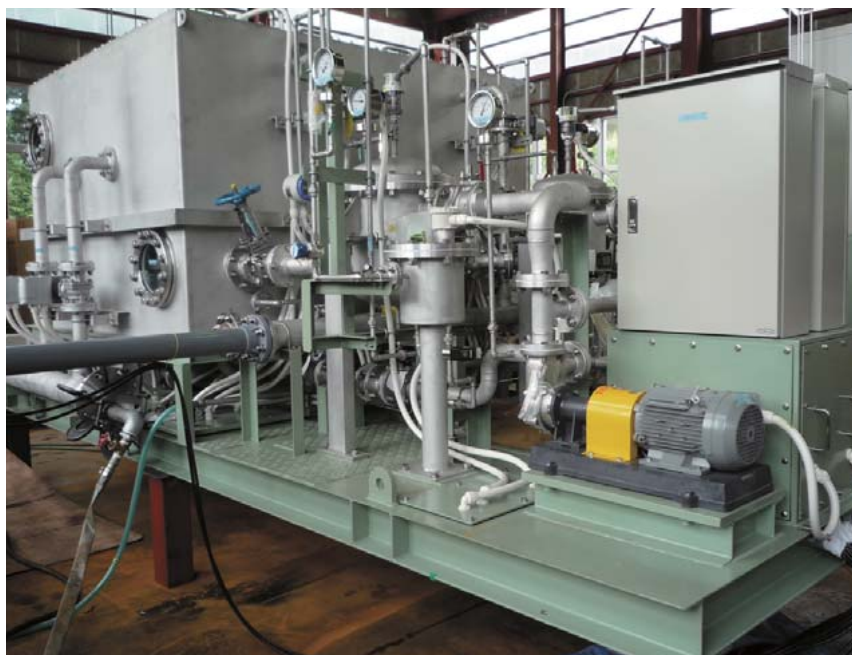
4 オゾンマイクロバブル下水再生装置（日量600 m³）の外観
