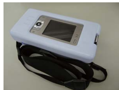
2 列車運転状況表示装置
