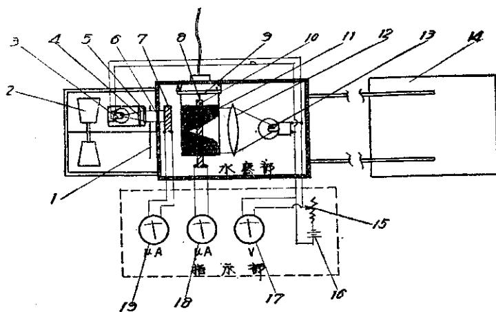
光電池に光が当ると電流が流れ、しかもその大きさは光電池に当る光の量に比例するが、本流向計はこのような物理現象を利用したものである。即ち、流向計器体と方位磁石とのなす角度の変化を光の量の変化に變え、更に光電池を流れる電流の変化に變え、これをマイクロアンメーターで讀むことにより方位を知る事が出来るようになっている。圖により構造を説明する。
