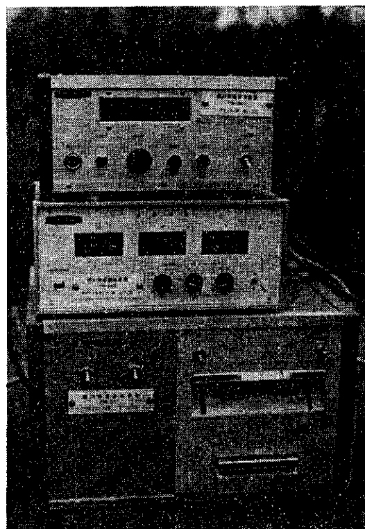
写真-2 河川砂面計制御部 (上段カウンター, 中段デジタルタイマー, 下段デジタルプリンター)
