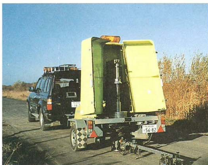
写真-1 FWD によるたわみ量測定の様子
