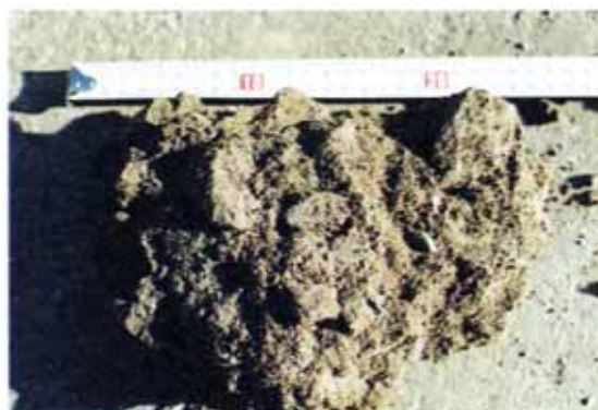
写真-1 再生骨材の固結状況
