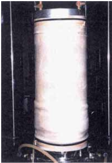
生石灰処理土（添加率5%）の繰返し載荷終了後の供試体の一例。繰返し載荷によって供試体の下部が一部破壊しその部分のみ液状化した。試験後も供試体の大部分は液状化には至らず、試験前と同様に自立している。
