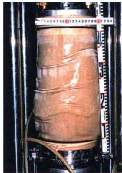
セメント処理土（添加率5%）の繰返し載荷終了後の供試体の一例。繰返し載荷によって供試体にせん断破壊が生じ、その部分が液状化した。試験後も供試体の大部分は液状化には至らず、試験前と同様に自立している。
