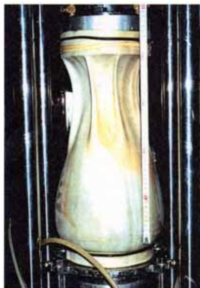
未処理土（火山灰土）の繰返し載荷終了後の供試体の状況。繰返し載荷によって供試体全体が液状化に至っている。メンブレンの中の試料は完全に液状化しており、供試体の下部は液状化した試料が流動して膨らんでいる。
