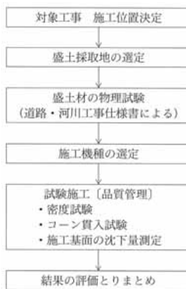
図-1 試験施工の流れ
