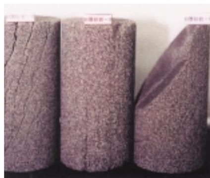
写真-2 凍結風化例（凍結融解後）
