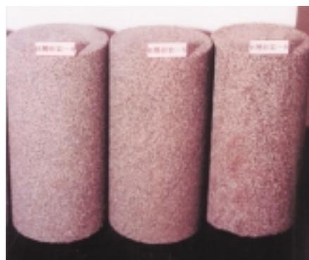
写真-1 凍結風化例（凍結融解前砂岩）
